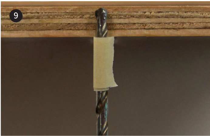
9 드릴로 합판에 완전히 구멍을 내지 않도록, 드릴 비트에 깊이용 가이드로 사용할 보호 테이프를 부착합니다.
