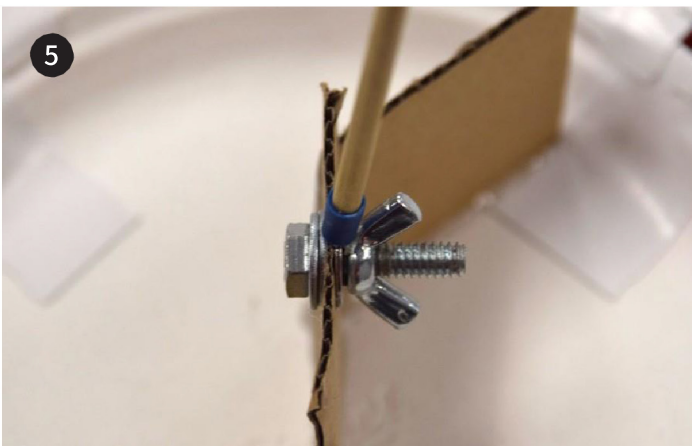
볼트, 와셔 및 wing 너트로 패널에 진자를 연결합니다. 이때 진자가 흔들릴 수 있을 정도로 느슨하게 유지합니다.
