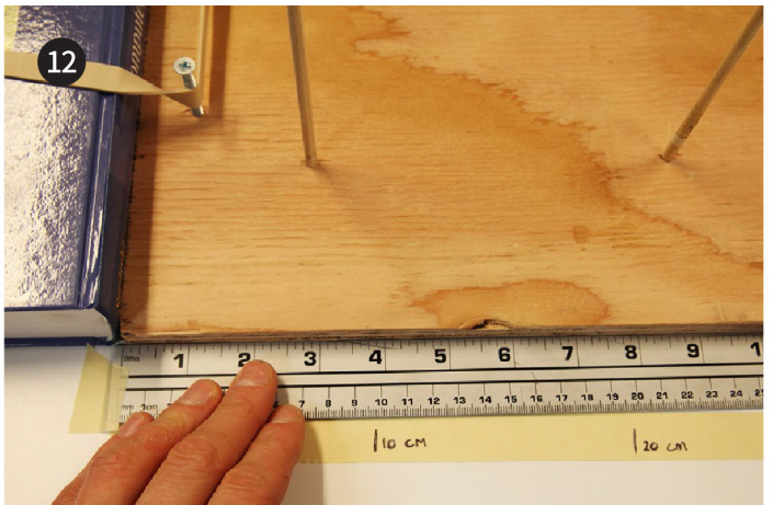
12 감쇠기 베이스 측면에 테이프로 미터 자를 붙입니다. 감쇠기 전면에서 10cm와 20cm 지점을 표시합니다. 감쇠기를 가이드 10cm와 20cm 지점까지 당겼다가 놓는 방식으로 눈금값의 차이를 테스트합니다.
