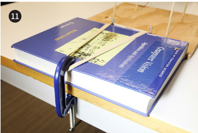
11 클램프로 큰 책 1권과 고무 밴드를 테이블에 고정시킵니다. 책 옆에 TMD를 놓고 고무 밴드를 나사 2개에 연결합니다.
