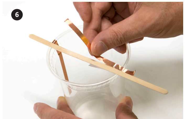
6 커피 젓는 막대로 구리 테이프를 정렬하고 고정합니다. 다른 구리 테이프와 마주 보고 정확히 중앙에 와야 합니다. 두 번째 구리 테이프를 4~5단계를 반복합니다.
