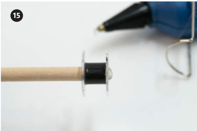
15 도웰을 보빈에 끼우고 글루를 말립니다. 도웰이 보빈 끝으로 약간 나와도 괜찮습니다.
