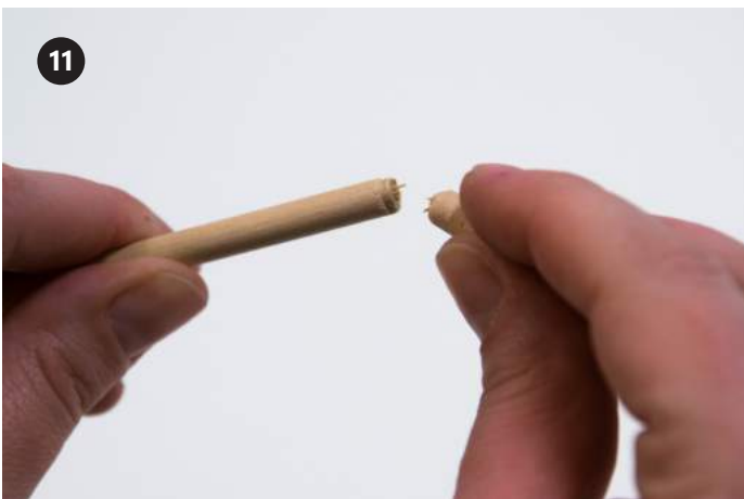
11 와이어 스트리퍼의 커팅 날을 사용하여 마크에 도웰에 자국을 냅니다. 손으로 쉽게 부러트릴 수 있어야 합니다.
