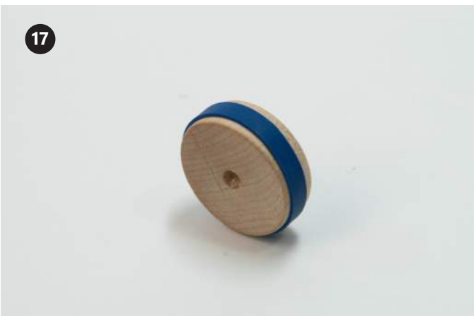
17 나무 바퀴를 찾습니다. 바퀴 주변을 작은 고무밴드로 감아서 미끄러지지 않게 합니다.
