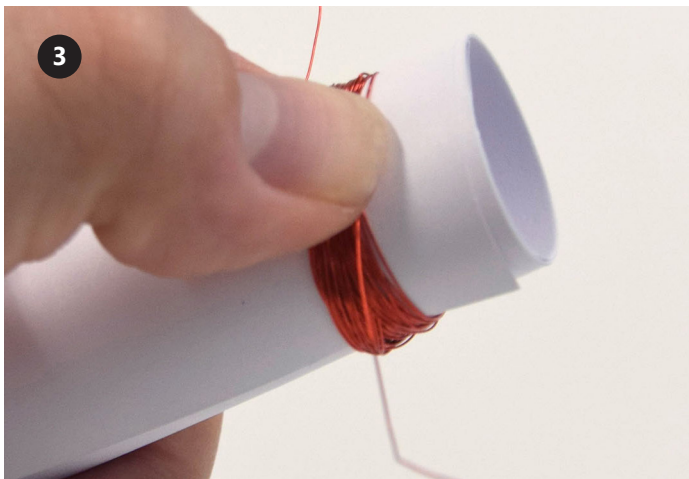
3 와이어 리드용으로 약 10cm를 남기고 약 50회 감습니다. 많이 감을수록 스피커 소리가 커집니다.
