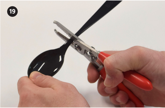
19 블레이드 설계에 맞게 스푼 4개의 손잡이를 잘라냅니다. 다른 재료로도 실험해보시기 바랍니다.
