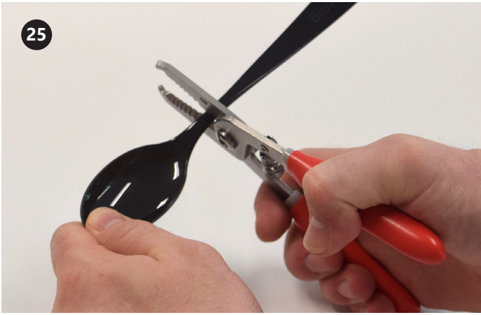
25 블레이드 설계에 맞게 스푼 4개의 손잡이를 잘라냅니다. 다른 재료로도 실험해보시기 바랍니다.
