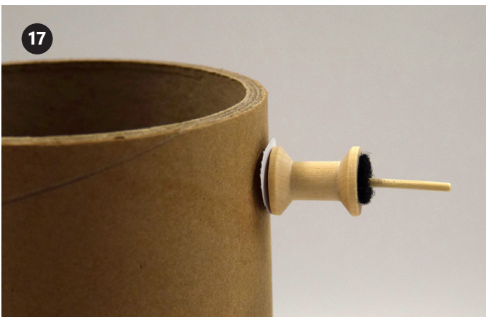
17 벨크로는 블레이드를 고정하는 역할을 하며, 이를 이용하면 쉽게 바꿔서 다른 블레이드 설계를 시도해볼 수 있습니다.
