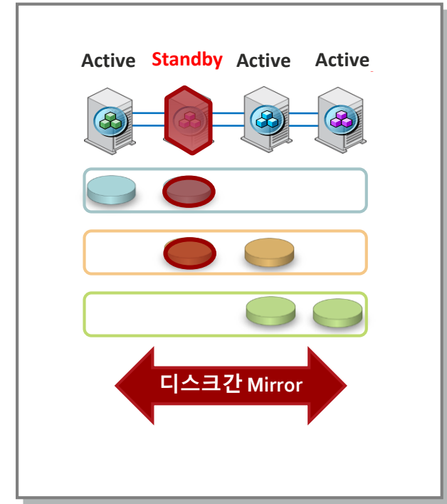
InfoScale을 통한 Standby 서버 최소화 및 모든 업무의 이중화
