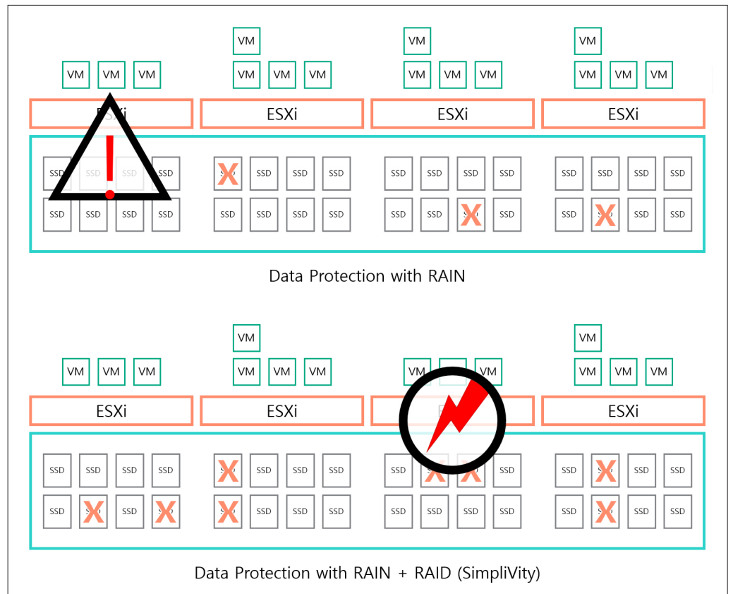
일반적인 RAIN 아키텍처와 HPE SimpliVity의 RAIN+RAID 아키텍처는 시스템 안정성에서 큰 차이가 있다.
