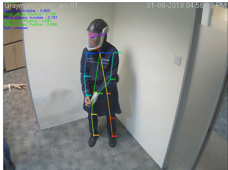
HPE와 Graymatics가 공동 개발한 PPE 확인 시스템. 규정된 안전 도구를 착용했는지 자동으로 확인한다.
