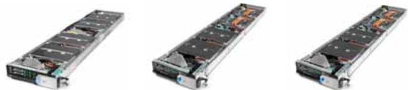
▲ HPE Apollo XL730f Server tray, Rack 당 최대 80개 tray 설치 가능
