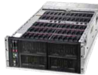
HPE Apollo 4510 4U 크기에 최대 68개의 핫스왑 LFF 및 2소켓 4U서버 1대 장착 가능
