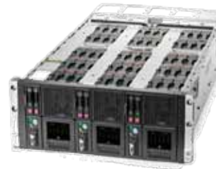
HPE Apollo 4530 4U 크기에 45개의 핫스왑 LFF 및 2소켓 서버 3대 장착 가능
